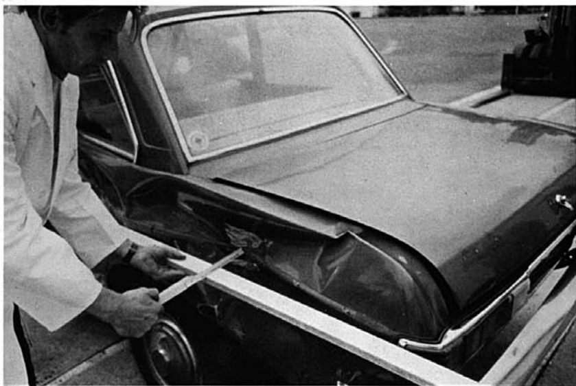
Die Eindringtiefe ohne Schaumfüllung beträgt hier 12 cm. Man beachte, daß sich ein Teil unter den Kofferdeckel geschoben hat.
