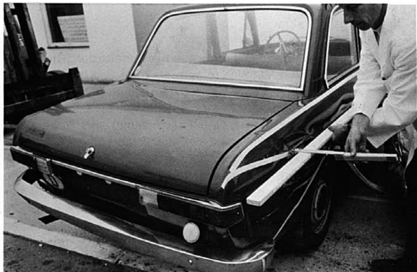
Auf der ausgeschäumten Seite beträgt die Eindringtiefe 4 cm. Ein solcher Schaden ist schnell repariert.
