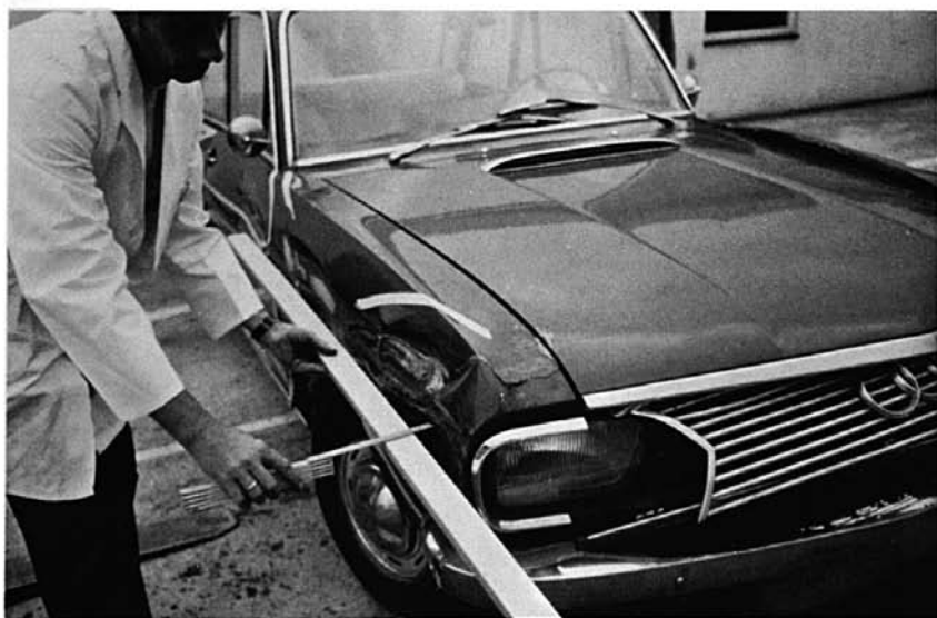
Einbeulung mit Schaumfüllung = 3 cm.
