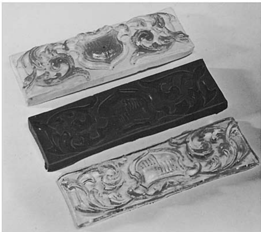
Le moule central a été fait à l'aide du caoutchouc silicone. La partie supérieure a été faite en 2 coulées dont la première a été teintée en vert.
