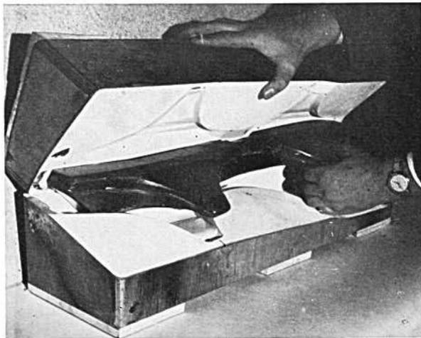
**Geöffnete Formen mit geschäumtem Formteil**, das allseitig mit einer ABS-Folie umhüllt ist. Die Folie wird vor dem Schäumvorgang in die Form eingelegt und verbindet sich ohne zusätzliche Verklebung mit dem Hartschaumkern.
