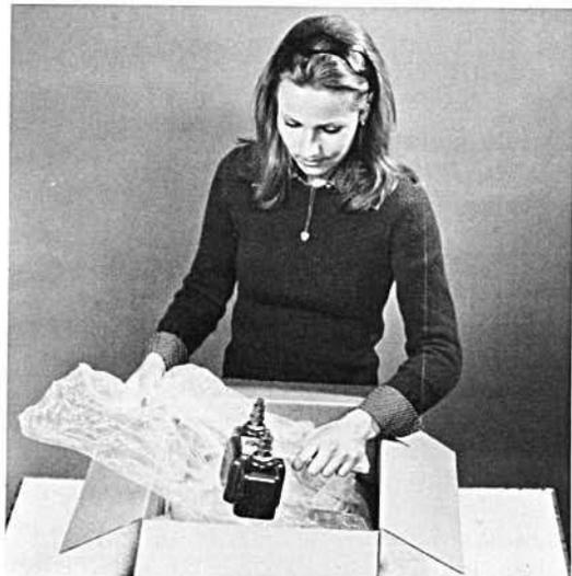
2) Über dem aufsteigenden Schaum wird die Folie zusammengelegt und das zu verpackende Teil so in den Karton gehalten, daß es – von der Folie gegen den Schaum abgeschirmt – bis zur Hälfte umschäumt wird.
