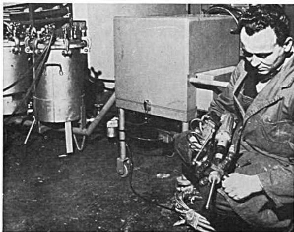
**Automatisch gesteuerte Verschäumungsanlage** zum Einbringen genau dosierter Schaummengen für die Formteillfertigung. Einstellung der Taktzeiten mittels eines Impulzzählwerkes.
