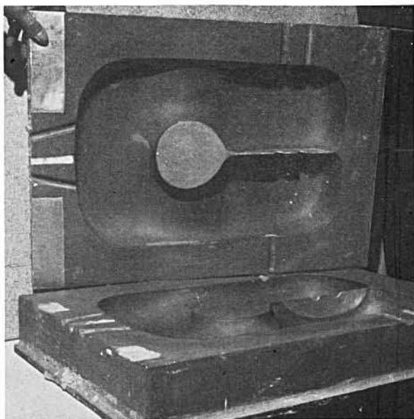
Geöffnete Form zur Herstellung eines Formteiles. Die Entlüftungsbohrungen sind deutlich zu erkennen.
