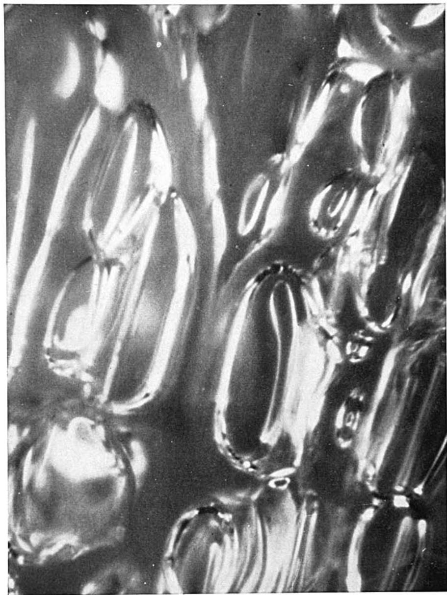
Hart-Schaumstoff HR — manuell verschäumt — Vergrößerung ca. 500 : 1, Aufnahme mit
