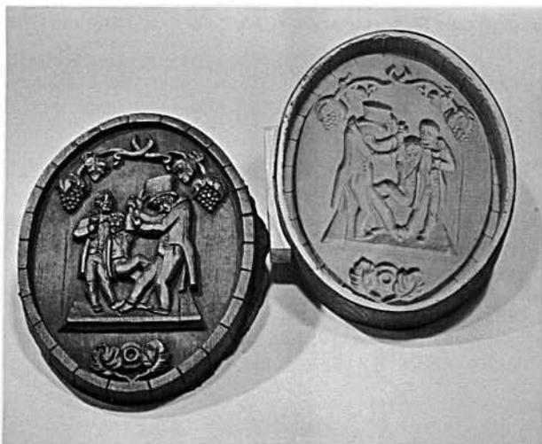
Dieses Faßbild in der Abmessung  $60 \times 40 \times 5$  cm wurde in einem Guß mit Integralschaum H 75 aus der nebenliegenden Silicon-Kautschukform gefertigt.
