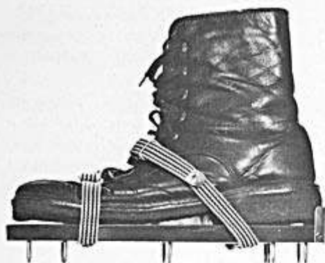
Fakirssole zum Unterschnallen unter die Arbeitsschuhe beim Beschichten
