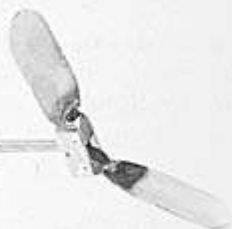
Faßrührer mit Klappflügeln zum Aufmischen von Harz im Faß
