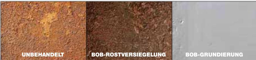
sche Reaktionen Feuchtigkeit, verfestigt und versiegelt die Oberfläche. Der Untergrund braucht nur handentrostet werden. Bereits nach ca. einer Stunde kann mit dem **BOB Spezial-Grundprimer** weiter gearbeitet werden. Der Grundprimer ist speziell auf die **BOB Rostversiegelung** abgestimmt und wird möglichst zweimal aufgetragen. Schon nach ca. ein bis zwei Stunden Trockenzeit wird der Decklack aufgetragen. Geeignet sind alle handelsüblichen einkomponentigen und zum Teil
