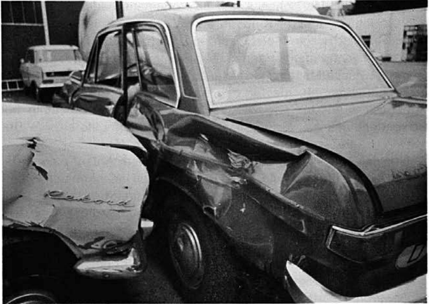
Der gleiche Aufprallversuch ohne Schaumfüllung auf der anderen Seite des Fahrzeuges zeigt einen wesentlich größeren Schaden .
