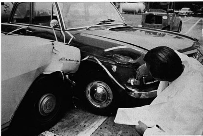
Mit Schaumfüllung des Vorderkotflügels. Anhand der Schrammen erkennt man deutlich das Abgleiten der beiden Fahrzeuge aneinander. Durch die Abbremsung über einen längeren Weg ist die Verzögerung geringer und der Stoß, dem die Insassen ausgesetzt sind, bleibt dadurch geringer.
