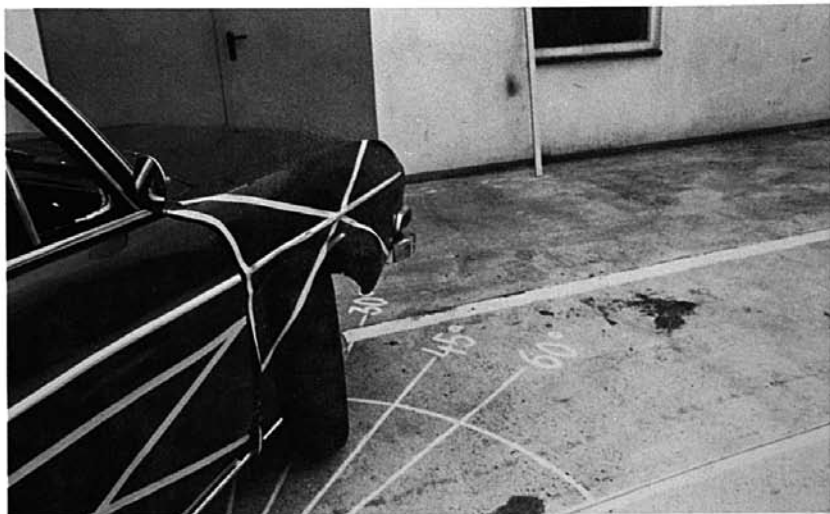
Aufprallversuch aus 45° schräge von vorne auf den Vorderkotflügel eines Audi mit einem Rekord, der an einem Seil auf 15 km/h beschleunigt wird.
