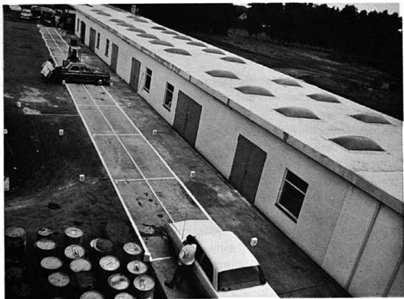
Teststrecke zur Durchführung von Aufprallversuchen auf dem Werksgelände der VOSSCHEMIE, Uetersen. Das aufprallende Fahrzeug wird an einem Stahlseil mit verschiedenen Geschwindigkeiten gezogen.
