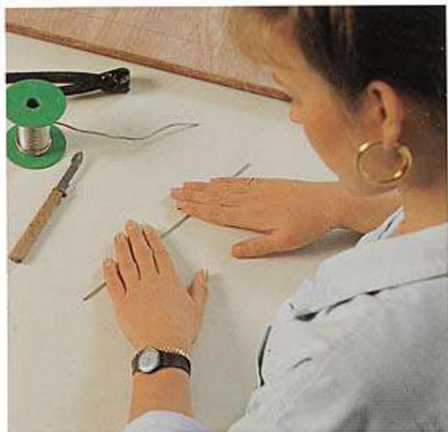
Il est conseillé de maintenir le fil métallique pendant sa mise en place, tous les 5 cms, à l'aide d'un ruban adhésif ce qui permet de contrôler que rien n'a bougé, au fur et à mesure du pliage et de la mise en forme du fil. On colle, définitivement, le fil rectiligne sur le support par des points de colle rapide.
