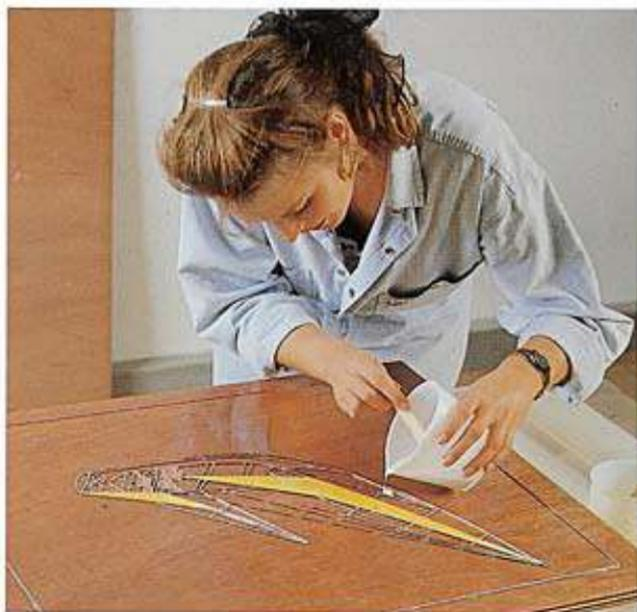
Des champs longs et étroits ne sont pas toujours faciles à couler, quand l'espace entre les bords est trop restreint. Il faut prendre la résine mélangée et la verser, goutte à goutte à l'aide d'un batonnet, dans la fente.
