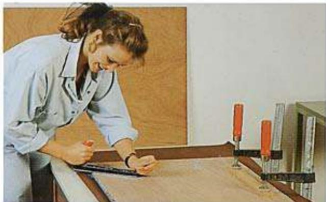
Autre méthode pour éliminer les gouttelettes: le réchauffement à l'aide d'un flux d'air chaud qui ramollit les résines et permet de gratter les gouttelettes avec un ciseau à bois ou une spatule métallique.
