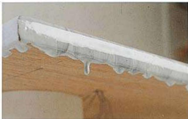
Les bulles d'air ont d'autant plus de peine à venir en surface que la résine aura déjà épaissi. Le remède consiste en un réchauffement de la surface à l'aide d'un flux d'air chaud (pistolet à air chaud) ou d'un bon sèche-cheveux. Le réchauffement diminue la tension de surface permettant l'éclosion des bulles.
