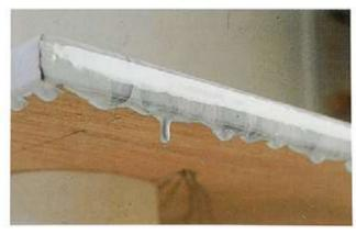
Ins Harz eingerührte Luftbläschen steigen besonders schlecht an die Oberlläche, wenn das Harz bereits etwas dickflüssiger geworden ist. Abhilfe bringt kurzzeitiges Erwärmen der Oberfläche mittels Heißluftpistole oder Fön zur Verringerung der Oberflächenspannung, so daß die Bläschen aufsteigen und platzen können.
