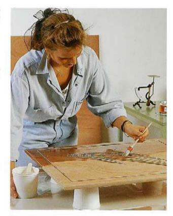
Durch die Oberflächenspannung des Harzes kriecht die Grundierung wie hier gezeigt an den Flanken des Konturdrahtes hoch und sorat. so auch bei nicht plan auf dem Holz aufliegenden Drahten für eine sichere Abdichtung. Dies gilt auch für die Drahtstöße, wenn die jeweilige Lücke nicht großer als 0,5 mm isl.
