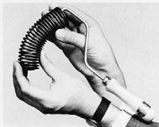
Flexibler Metallroller zum Entlüften des Laminates in positiven und negativen Rundungen
