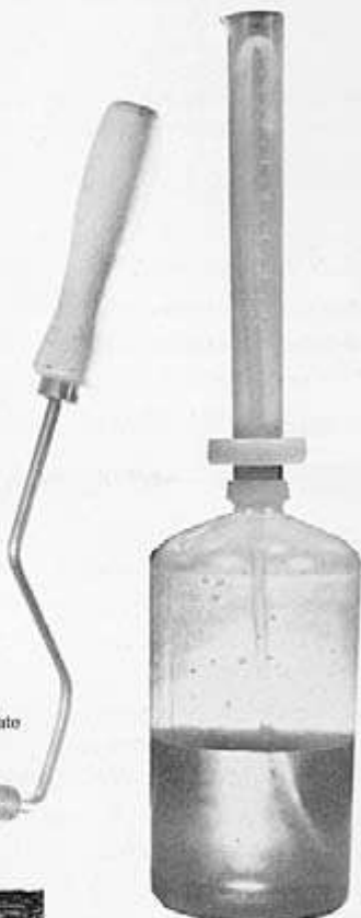
Dosierhilfe für MEKP-Härter
