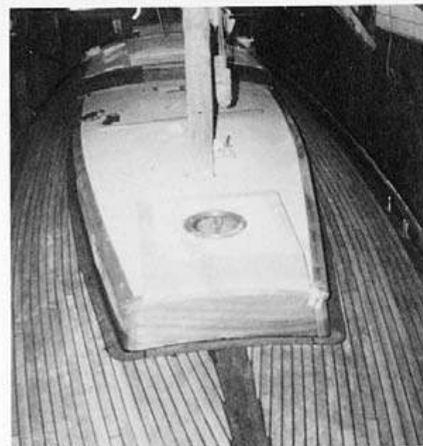
Ein dichtes Stabdeck
