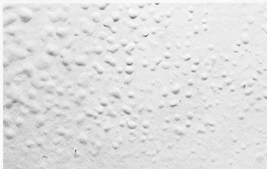
Prüfplatte zum Vergleich verschiedener Harze bei Wasserbelastung
