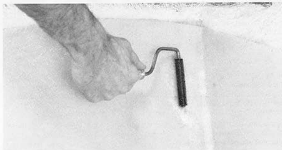
Die Arbeit mit eingefärbtem Harz erschwert das Entlüften
