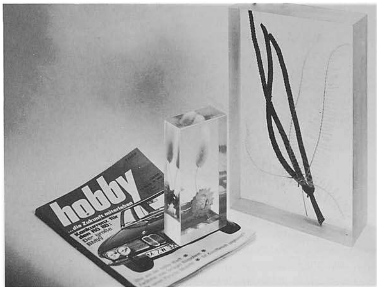
Farnkräuter, Ähren und Strohblumen lassen sich zu reizvollen Kombinationen eingießen. Der große Block hier hat die Maße 175 \times 270 \times 55 mm und wiegt 3,2 kg. Er wurde in nur 2 Aufgüssen hergestellt. Die erste Schicht war 0,5 kg, die letzte also 2,7 kg GTS-Harz.
