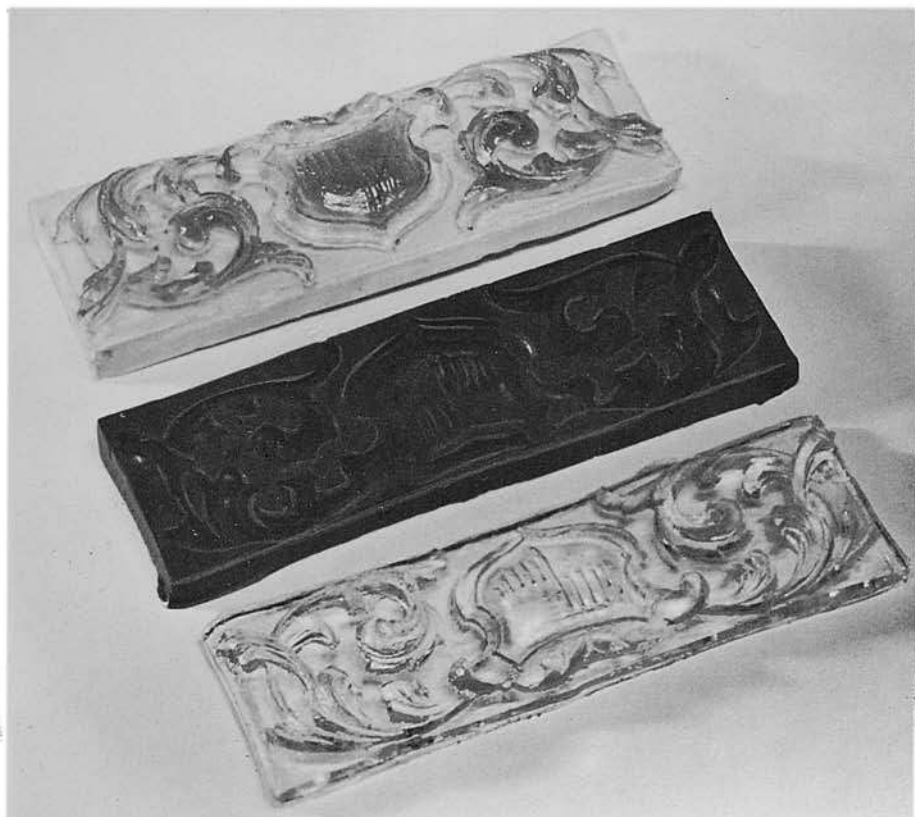
Die mittlere Form wurde vom Original abgenommen mit Silikon-Kautschuk. Das obere Formteil wurde in 2 Schichten eingegossen, wobei die erste Schicht grün eingefärbt wurde.
