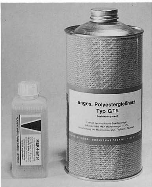
Gießharz Typ GTS ist im flüssigen Zustand schwach grünlich. Bei der Aushärtung wird es kurz vor der Gelierung plötzlich wasserhell.
