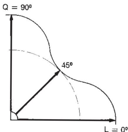
Will der Bootsbauer die verstärkende Wirkung des Gewebes voll nutzen, so legt er die Fäden in die Haupt-Krafrichtung, meistens längs und quer, bei Segelyachten zum Teil auch diagonal zur Fahrtrichtung.
