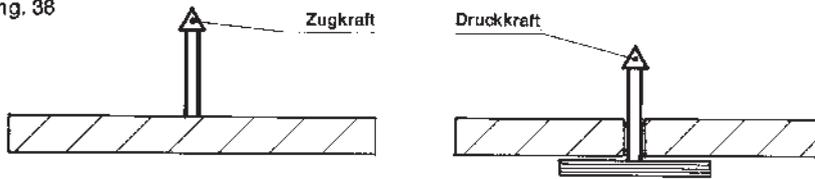
**Umwandlung einer Zugkraft senkrecht zum Laminat in eine Druckkraft**
